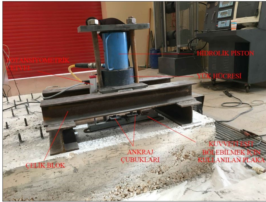
Şekil 5.4. Deney düzeneğinin gösterimi.
