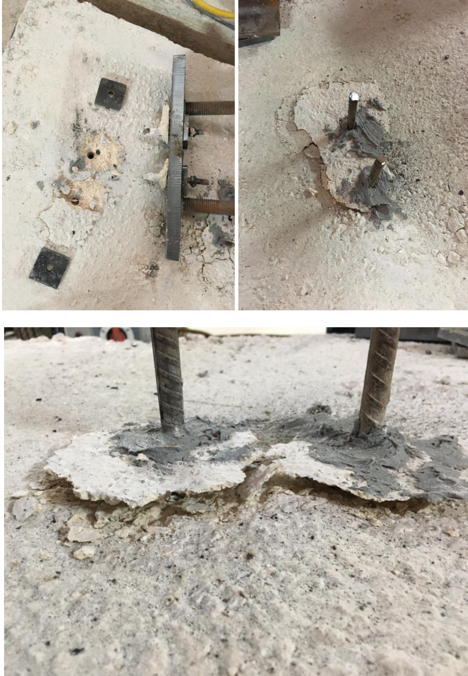
Ek3: N12L40-80-120 ankraj grubuna ait deney fotoğrafları
