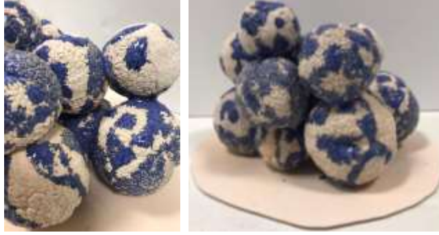
Resim 11: Beyaz bünyenin sır pişirimi sonrası görüntüsü. (R-9 %3 kobalt oksit, 1000°C), (Beyza Nur KUM arşiv, 2022)
