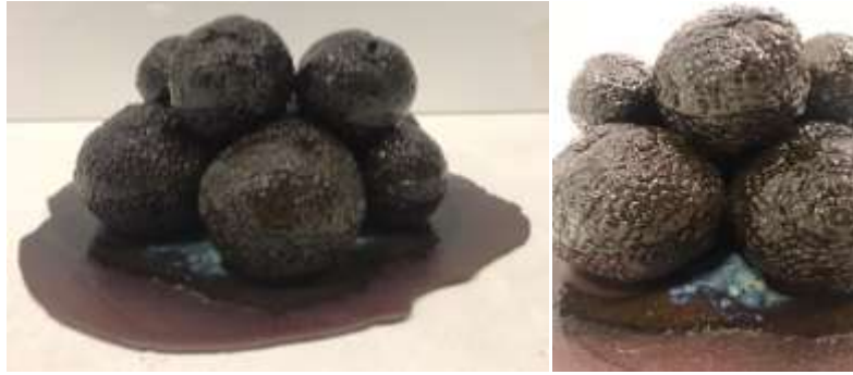
Resim 7: Kırmızı bünyenin sır pişirimi sonrası görüntüsü. (R-1 %1 bakır oksit, 1200°C), (Beyza Nur KUM arşiv, 2022)
