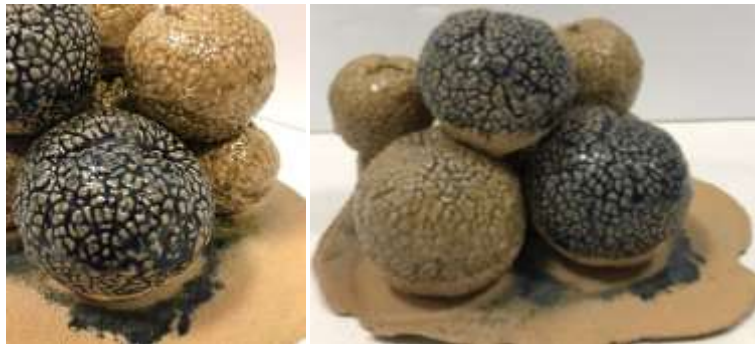
Resim 9: Şamotlu bünyenin sır pişirimi sonrası görüntüsü. (R-1 %1-3 kobalt oksit, %1 bakır oksit,
