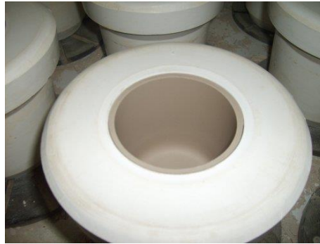
Şekil 3.5. Torna işlemi sonrası kalıptan çıkarılmayı bekleyen ürün (Kılıçarslan Seramik).
