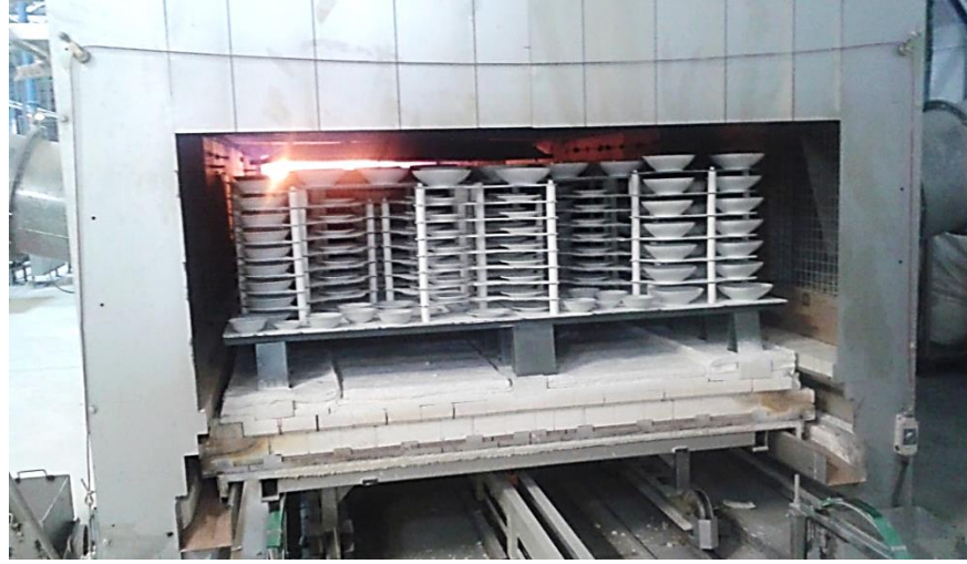
Şekil 3.27. Endüstriyel ölçekli tünel formda sırlı fırın (Porland Porselen A.Ş.)
