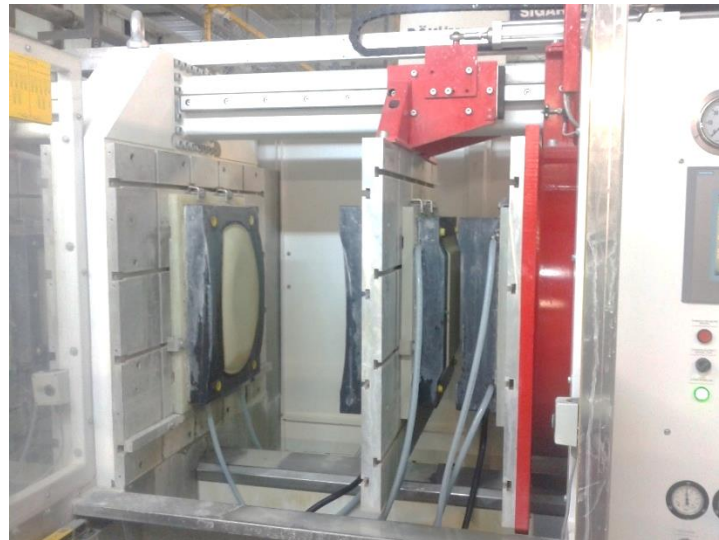
Şekil 3.10. Basınçlı döküm makinesi (Porland Porselen A.Ş.).
