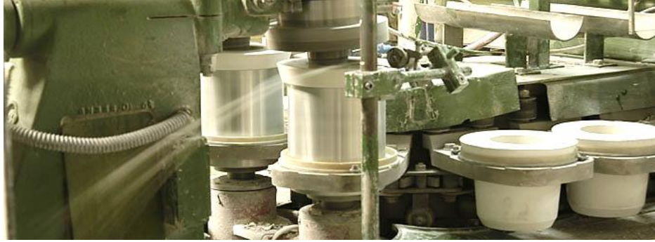
Şekil 3.4. Tornalama işlemi (Porselenin Üretim Aşamaları).
