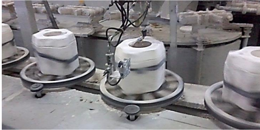
Şekil 3.8. Otomatik hassas döküm işlemi (Porland Porselen A.Ş.).
