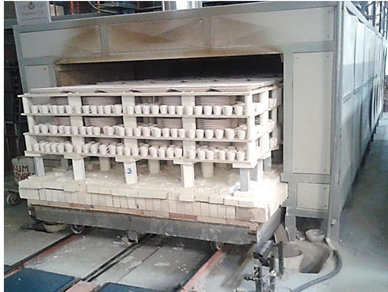
Şekil 3.19. Endüstriyel ölçekli sırsız gövde pişirimi yapılan tünel fırın (Portland Porselen A.Ş.).
