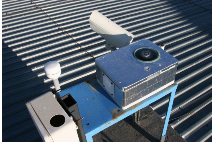
Şekil 3.1 TUG tüm gökyüzü kamera sistemi
