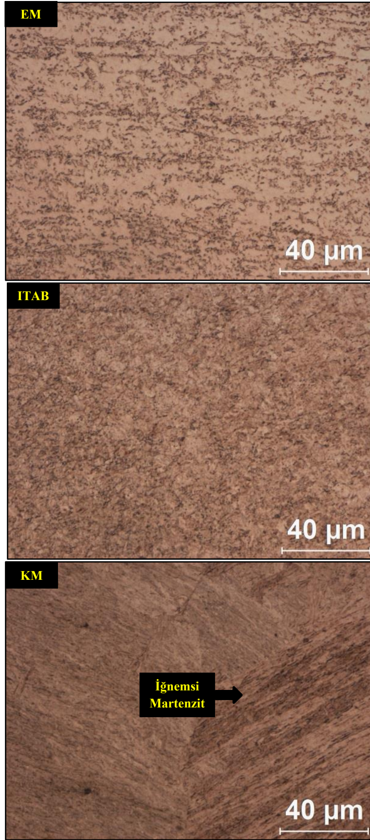
Şekil 4. EM, ITAB ve KM Bölgelerinden Alınan Optik Mikroskop Görüntüleri ( Optical Microscope Images Taken from BM, HAZ, and WM Regions )
