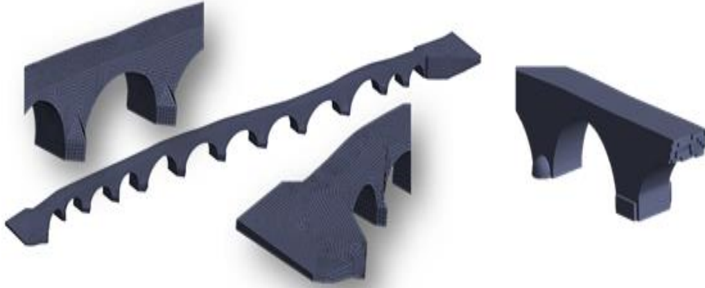
Şekil 3.4. Tarihi Murat Köprüsü Modeli ve Mesh Görüntüsü
