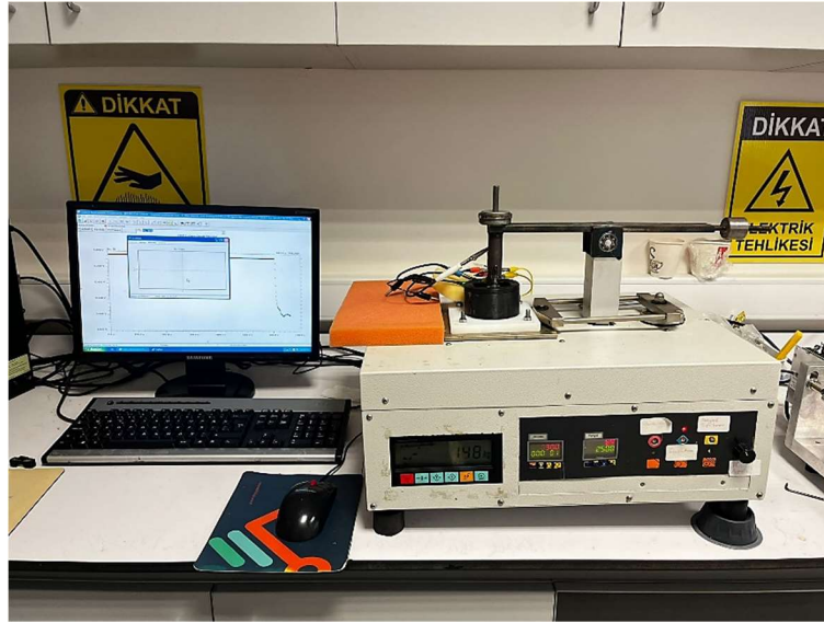
Şekil 8.11. Tribokorozyon deney düzeneğinin şematik gösterimi
