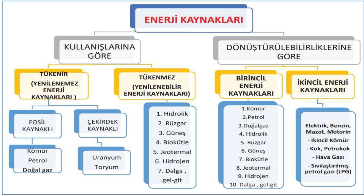
Şekil 3.1. Enerji Kaynaklarının Gruplandırılması (Koç vd., 2018).
