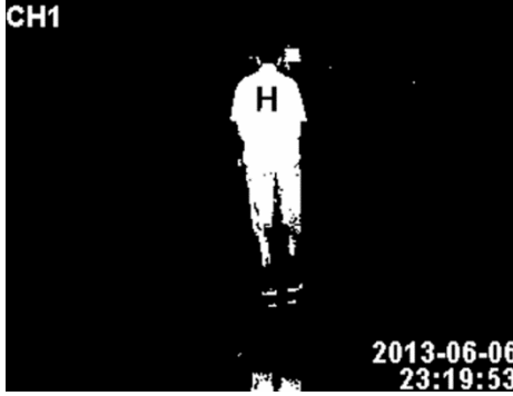
Şekil 6: Önişlemeden geçmiş ikili görüntü.
