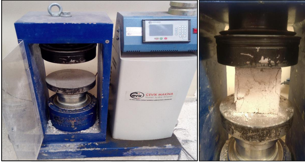
Şekil 3.7. Basınç dayanımını testinde kullanılan bilgisayar kontrollü pres
