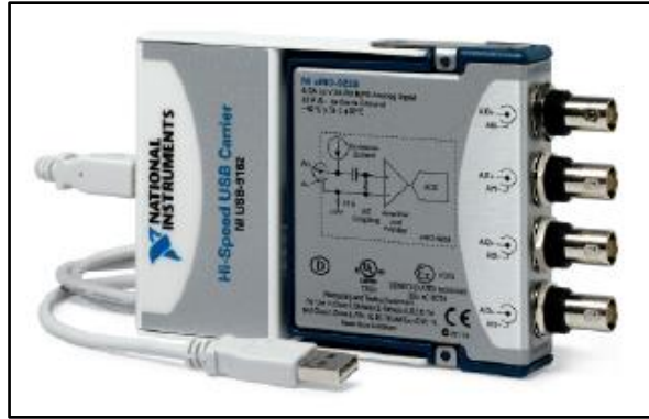
Şekil 3.13. NI 9233-USB-9162 veri toplayıcı.
