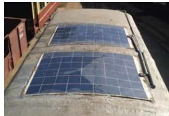
Şekil 3.3. Vagon Üstü Güneş Panelleri
