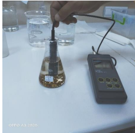
Şekil 3.4. İletkenlik Değerinin Ölçümü
