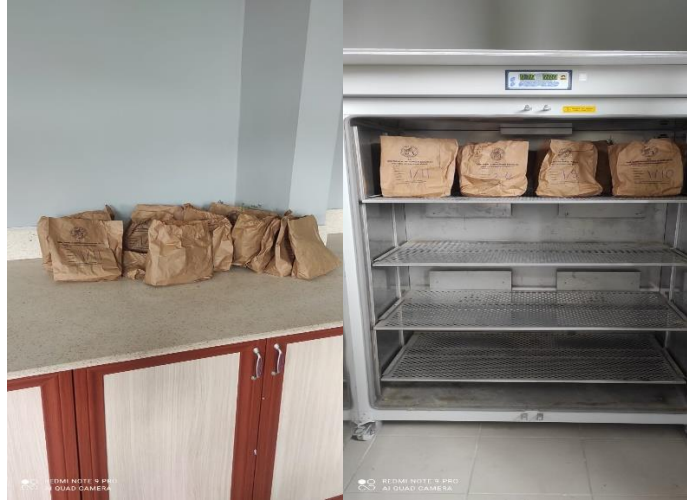
Şekil 3.10. Yeşil ot numunelerini kurutma soldurma işlemleri
