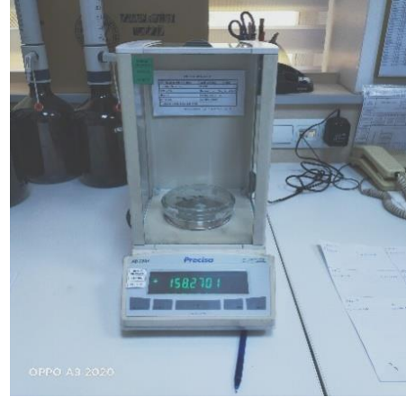
Şekil 3.2. Tohumların ağırlıklarının ölçümü
