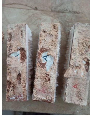
Şekil E.21. Sodyum silikat/sodyum hidroksit oranı 1/1 olarak kullanılan, 50gr yüksek fırın cürufu katkılı YA numunesinde kusma
