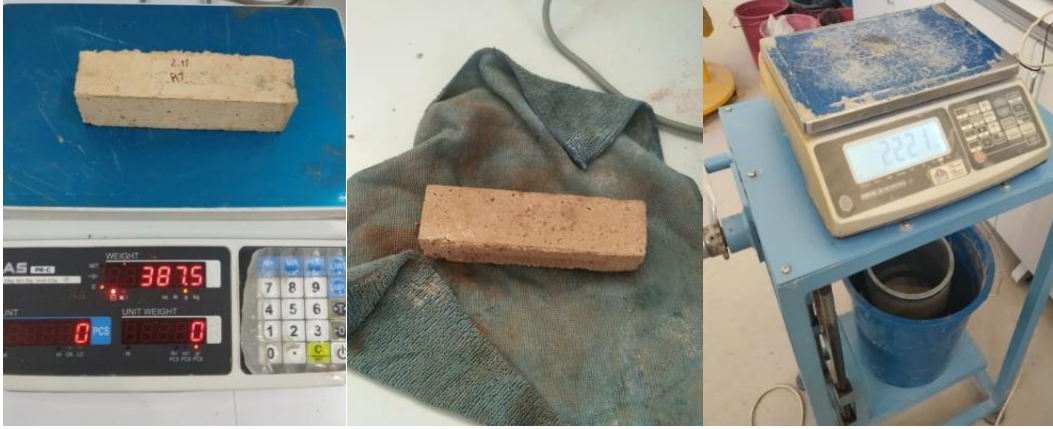
Şekil 4.8. Su emme oranı ve porozite tayini
