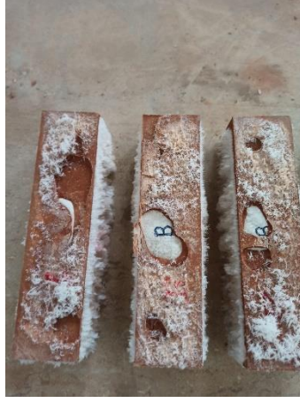
Şekil E.22. Sodyum silikat/sodyum hidroksit oranı 1/1 olarak kullanılan, 100gr yüksek fırın cürufu katkılı YB numunesinde kusma
