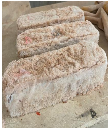
Şekil E.24. Sodyum silikat/sodyum hidroksit oranı 1/1 olarak kullanılan, 200gr yüksek fırın cürufu katkılı YD numunesinde kusma
