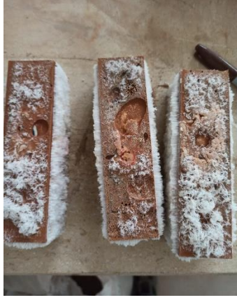
Şekil E.23. Sodyum silikat/sodyum hidroksit oranı 1/1 olarak kullanılan, 150gr yüksek fırın cürufu katkılı YC numunesinde kusma
