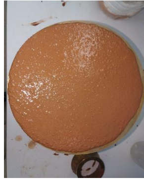
Şekil E.17. Aktivatör olarak sodyum hidroksit ve sodyum silikat içeren numunenin yayılması
