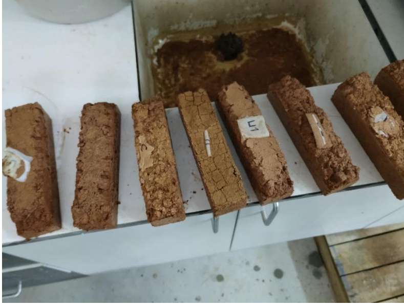
Şekil E.25. Kusma gözlemlenen numunelerde, 24 saat suda bekletildikten sonra oluşan bozulma
