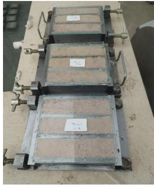
Şekil E.5. Kabuk suyu kullanılarak üretilen numuneler
