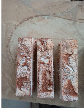
Şekil E.20. Sodyum silikat/sodyum hidroksit oranı 1/1 olarak kullanılan, puzolan katkısız M numunesinde kusma
