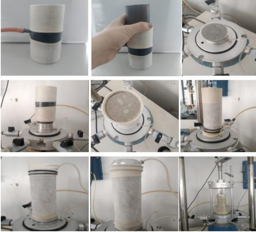
Şekil 4.14. Konsolidasyonlu-drenajlı üç eksenli basınç deneyine ait numunenin deney düzeneğine yerleştirilme aşamaları
