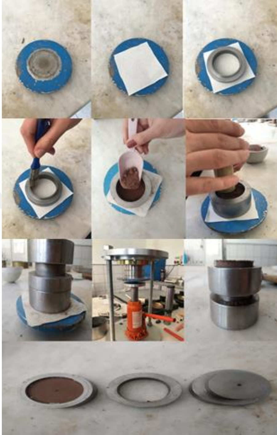
Şekil 4.6. Sıkıştırılmış numune elde etme aşamaları
