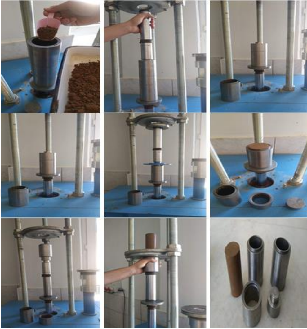
Şekil 4.13. Konsolidasyonlu-drenajlı üç eksenli basınç deneyine ait numunenin hazırlanma aşamaları
