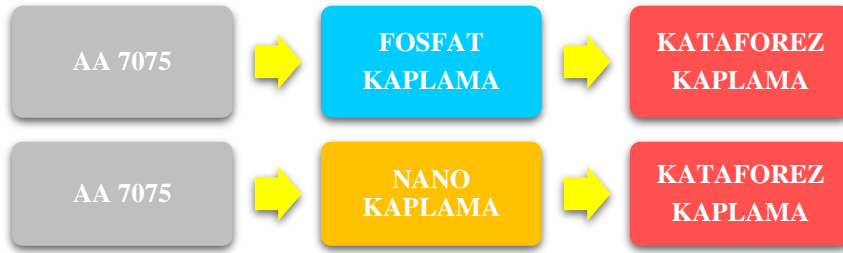
Şekil 1: Altlık yüzeyine uygulanan işlemlerin akış şeması
