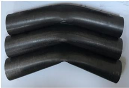
Şekil 4.5. Boru kesit profillerin üç farklı destek aralığında deforme olmuş halleri
