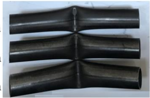
Şekil 4.5. Boru kesit profillerin üç farklı destek aralığında deforme olmuş halleri
