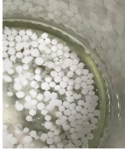
Şekil 5.2. Kitosan ve hBN İçeren Karışımın NaOH Çözeltisine Eklenmesi
