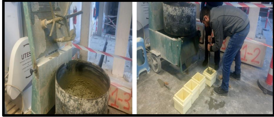
Şekil 4.4. Beton karışımların hazırlanması
