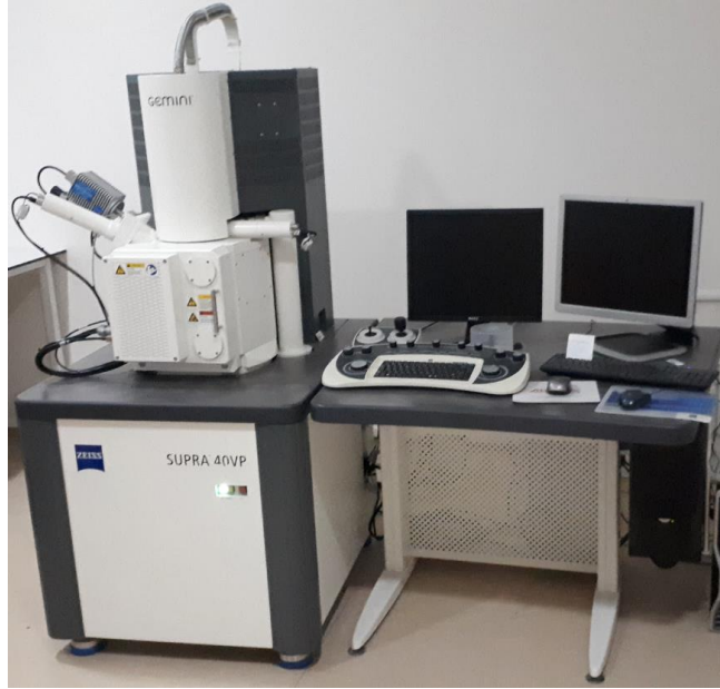
Şekil 3.8. ZEISS marka, SUPRA 40VP model taramalı elektron mikroskobu.
