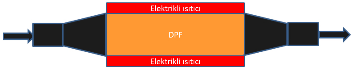
Şekil 2.11. Elektrikli ısıtıcı kullanarak DPF aktif rejenerasyonu (Lemon, 2014).
