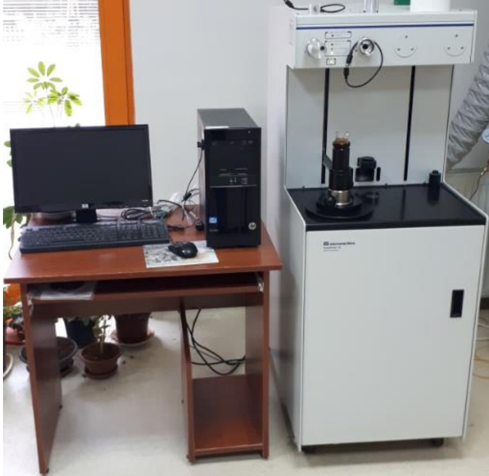
Şekil 3.6. MICROMERITICS marka, AUTOPORE IV model civa porozimetresi.
