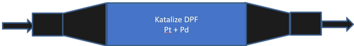
Şekil 2.14. Katalize DPF kullanarak DPF pasif rejenerasyonu (Lemon, 2014).
