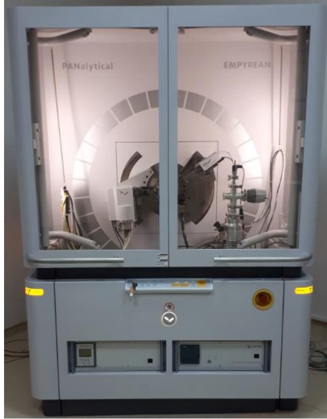
Şekil 3.7. PANalytical marka, EMPYREAN model XRD cihazı.
