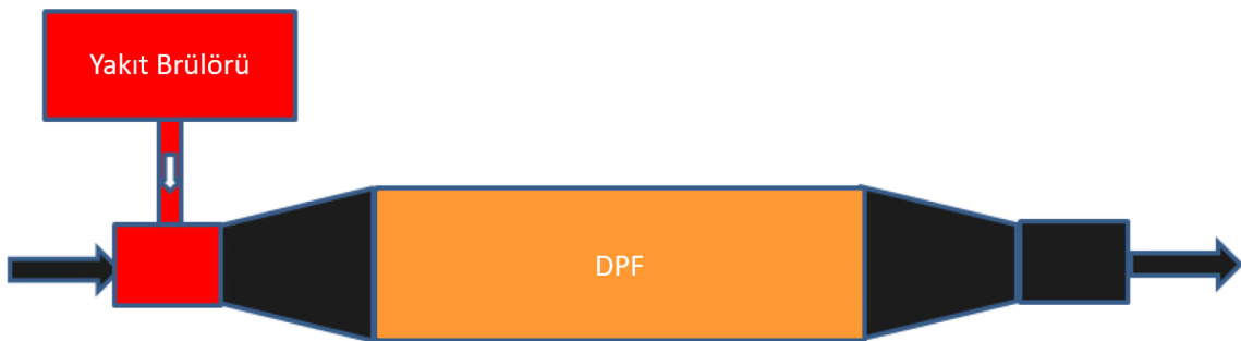
Şekil 2.12. Yakıt brülörü kullanarak DPF aktif rejenerasyonu (Lemon, 2014).
