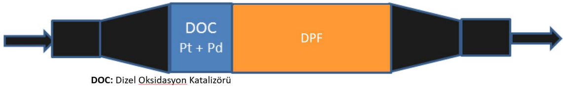
Şekil 2.13. Dizel oksidasyon katalizörü kullanarak DPF pasif rejenerasyonu (Lemon, 2014).
