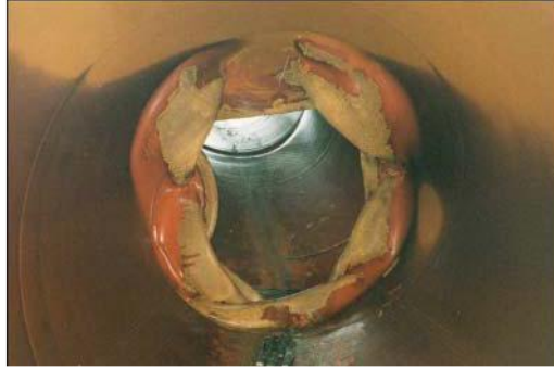
Şekil 4.3. Fay hareketi sonucunda boruda meydana gelen buruşma
