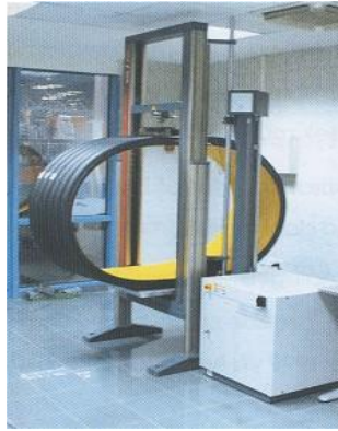
Şekil 2.1. Esnek borunun yük altındaki davranışı
