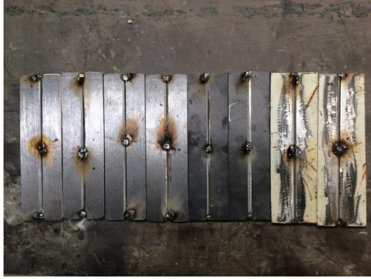
Şekil 4.1 Alın kaynağı için puntalanmış numune örnekleri.
