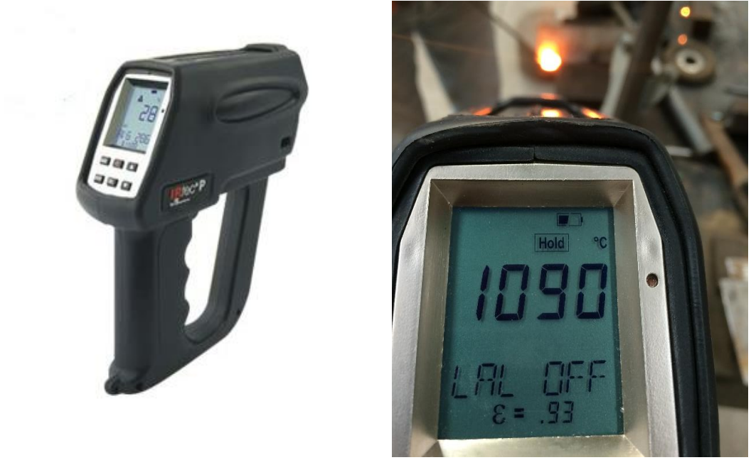
Şekil 4.4 IRtec P2000 Mk2 sıcaklık ölçüm cihazı.
