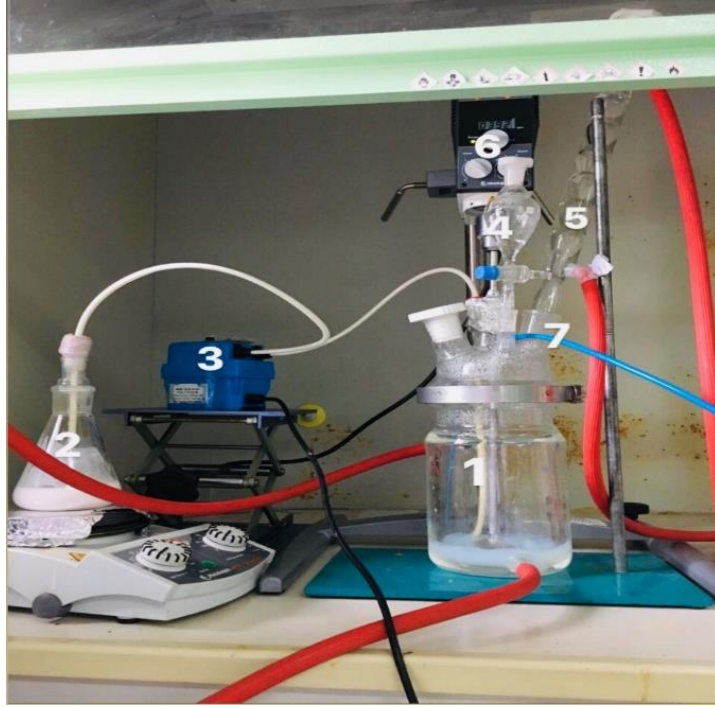
Şekil 3.1. SAC latekslerin sentezinde kullanılan deney düzeneği. (1. Su çeketli reaktör, 2. Emülsiyon çözeltisi, 3. Peristaltik pompa, 4. Başlatıcı çözelti, 5. Geri soğutucu, 6. Mekanik karıştırıcı, 7. Azot girişi).
