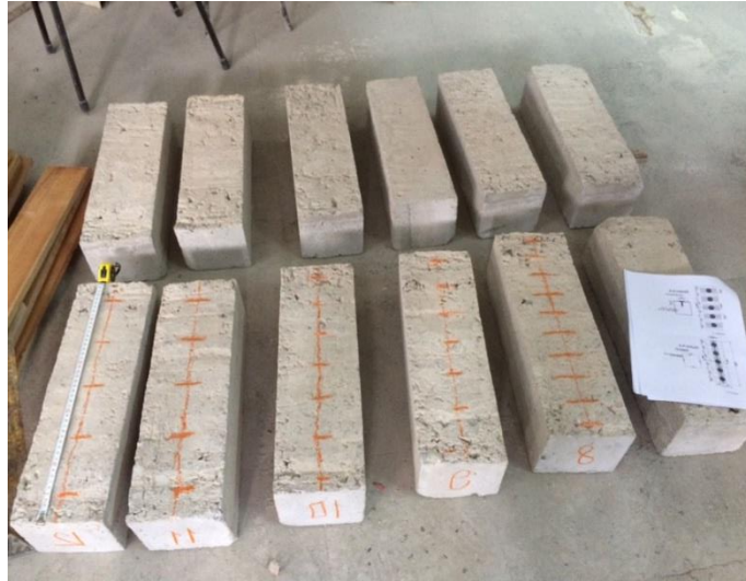
Şekil 3.20. CFRP yapışma yüzeylerinin temizlenmesi ve işaretlenerek hazırlanması.
