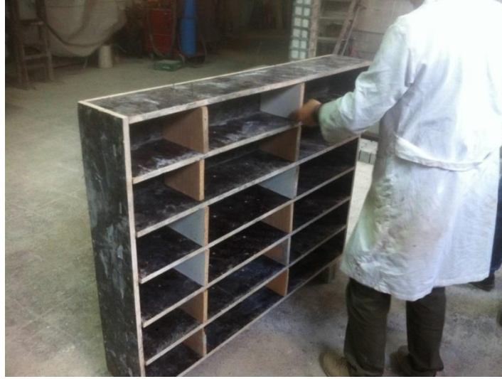
Şekil 3.13. Deney elemanlarının dökülmesinden kullanılan kalıp sistemi.
