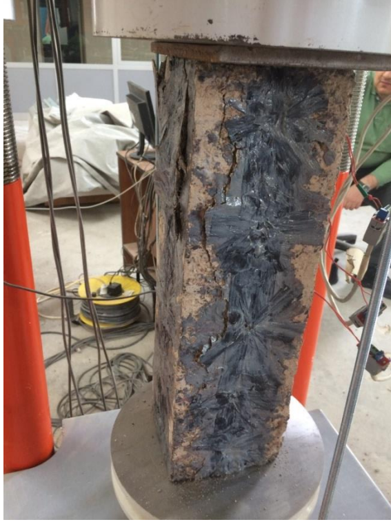
Şekil 4.32. Deney elemanı -11 üst ucunda betonda ezilmesi.
