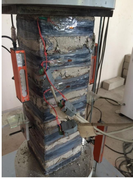
Şekil 4.8. Deney elemanı -3 üst ucunda betonda ezilme.
