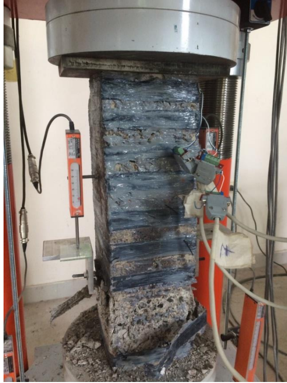
Şekil 4.6. Deney elemanı-2 alt ucundaki CFRP şeritlerin kopması sonucunda göçmesi.
