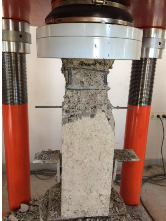
Şekil 4.3. Deney elemanı-1 boyuna donatılarının burkulması ve göçmesi.
