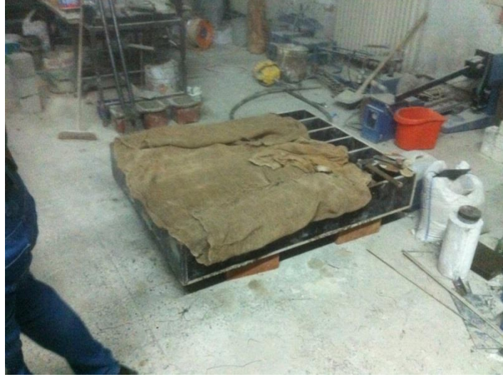
Şekil 3.17. Deney elemanlarının beton dökümü sonrası korunması.
