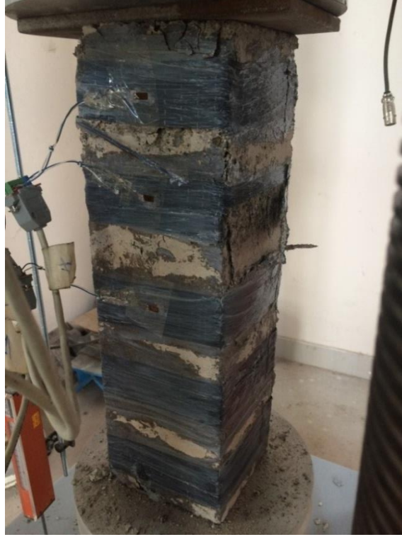
Şekil 4.29. Deney elemanı -10 üst ucunda betonda ezilmesi.
