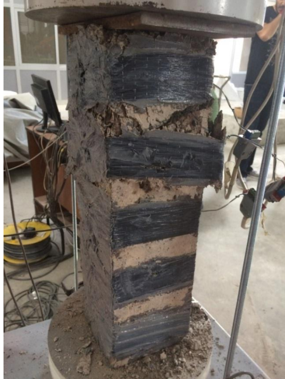
Şekil 4.30. Deney elemanı-10 üst ucundaki CFRP şeritlerin kopması sonucunda göçmesi.
