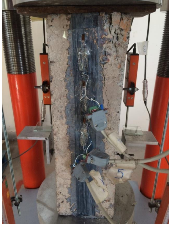
Şekil 4.17. Deney elemanı -6 üst ucunda betonda ezilmesi.
