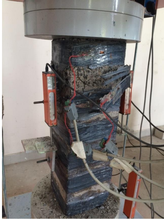
Şekil 4.26. Deney elemanı -9 üst ucunda betonda ezilmesi.
