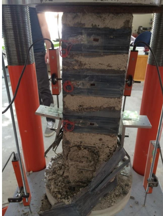
Şekil 4.15. Deney elemanı-5 alt ucundaki CFRP şeritlerin kopması sonucunda göçmesi.
