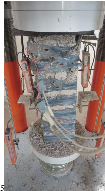
Şekil 4.24. Deney elemanı-8 üst ucundaki CFRP şeritlerin kopması sonucunda göçmesi.
