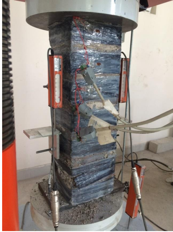
Şekil 4.11. Deney elemanı -4 alt ucunda betonda ezilme.
