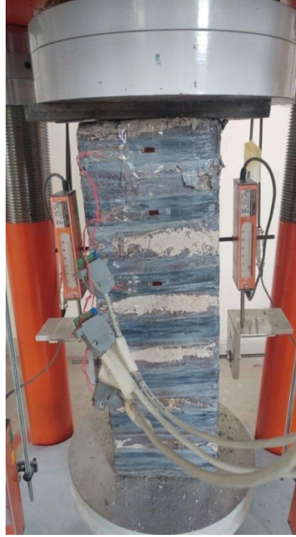
Şekil 4.23. Deney elemanı-8 üst ucunda betonda ezilme.
