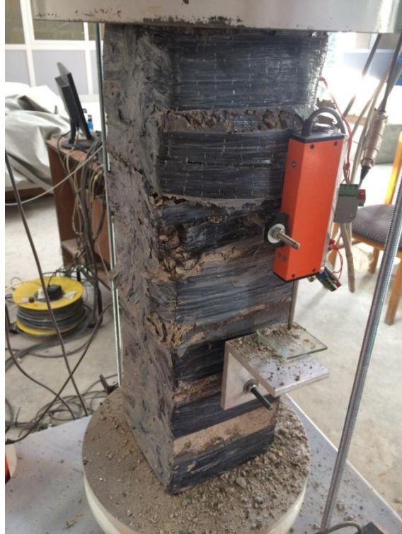
Şekil 4.27. Deney elemanı-9 üst ucundaki CFRP şeritlerin kopması sonucunda göçmesi.
