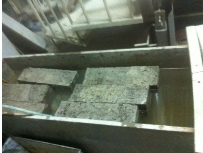
Şekil 3.18. Deney elemanlarına kalıptan çıkarıldıktan sonra kür uygulanması.
