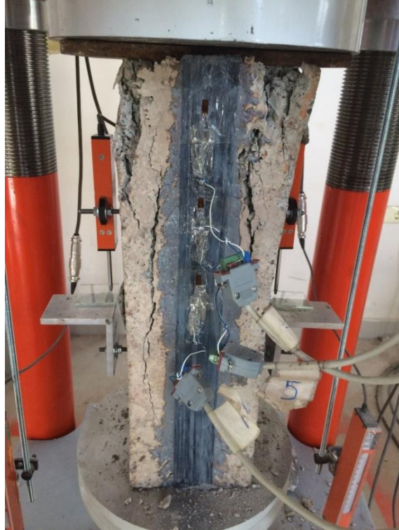
Şekil 4.18. Deney elemanı-6 CFRP şeridin yüzeyden soyulması sonucunda göçmesi.
