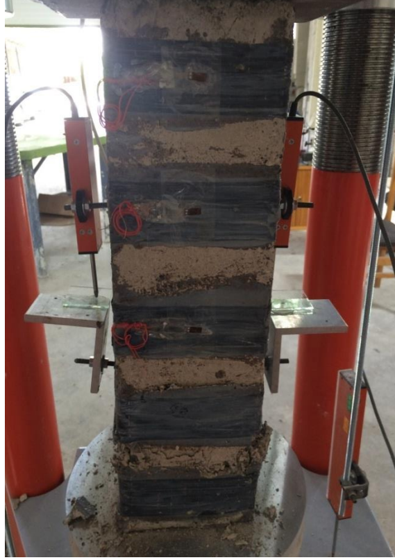
Şekil 4.14. Deney elemanı -5 alt ucunda betonda ezilme.
