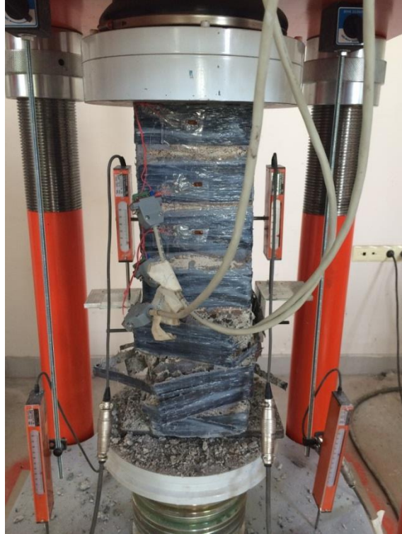
Şekil 4.12. Deney elemanı-4 alt ucundaki CFRP şeritlerin kopması sonucunda göçmesi.
