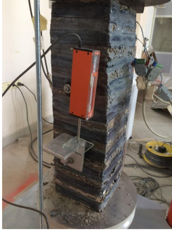
Şekil 4.5. Deney elemanı -2 alt ucunda betonda ezilme.
