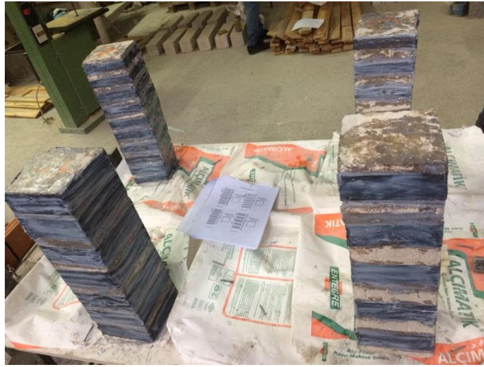
Şekil 3.21. CFRP yapıştırma işlemi tamamlanmış deney elemanları.
