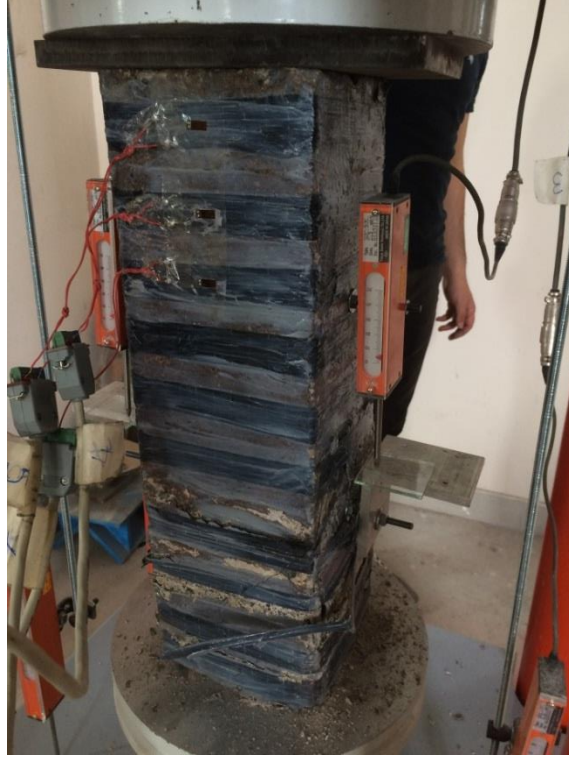
Şekil 4.20. Deney elemanı-7 alt ucunda betonda ezilme.
