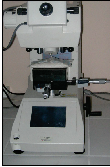
Şekil 5.2. Shimadzu mikrosertlik ölçüm cihazı.
