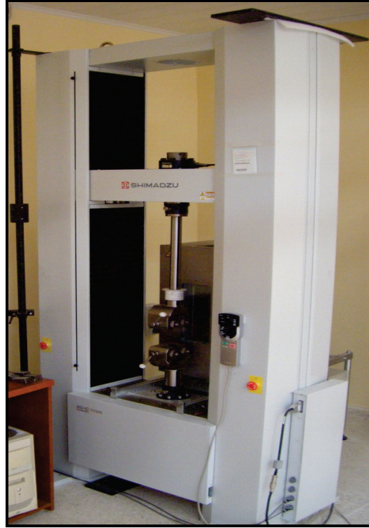
Şekil 5.3. Shimadzu AG-X marka universal test cihazı.
