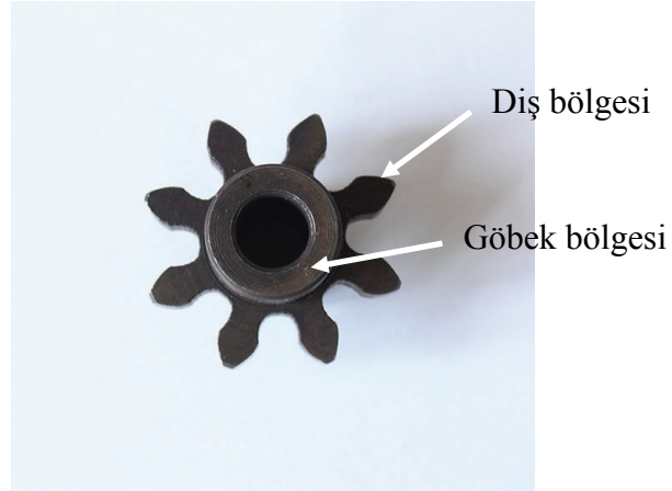
Şekil 5.1. Deneysel çalışmalarda kullanılan dişli numune.
