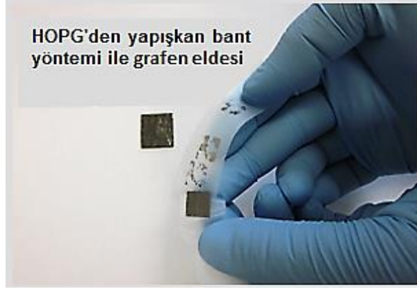
Şekil 3.7. Mikro mekanik olarak yüksek derecede yönlendirilmiş pirolitik grafit (Highly Oriented Pyrolytic Graphite-HOPG) tabakasının izolasyonu.
