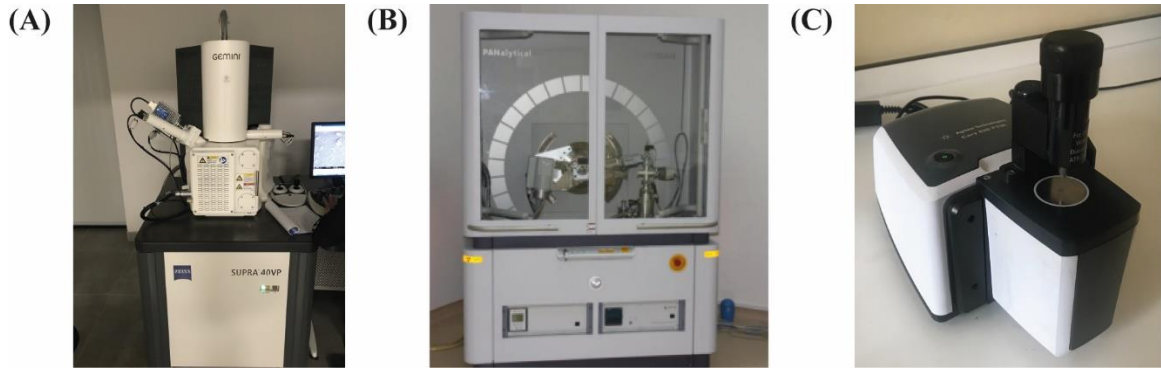
Şekil 3.1. Fiziksel ve kimyasal karakterizasyon için kullanılan (A) SEM/EDX, (B) XRD ve (C) FT-IR cihazları
