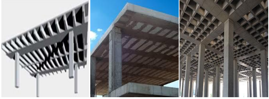
Şekil 3.2. Dişli (nervürlü) döşeme (a), asmolen döşeme (b), kaset döşeme (c) (Topçu,2018).
