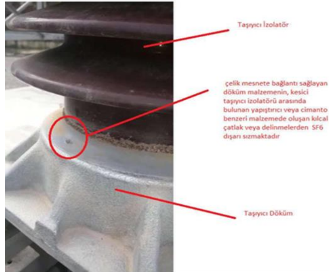
Şekil 4.22. Kesicide oluşmuş gövde delinme arıza durumu
