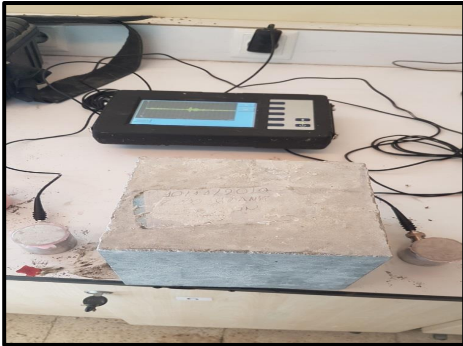
Şekil 5.13. Ultrases geçiş hızı deney cihazı ve deney uygulanan sertleşmiş beton numunesi
