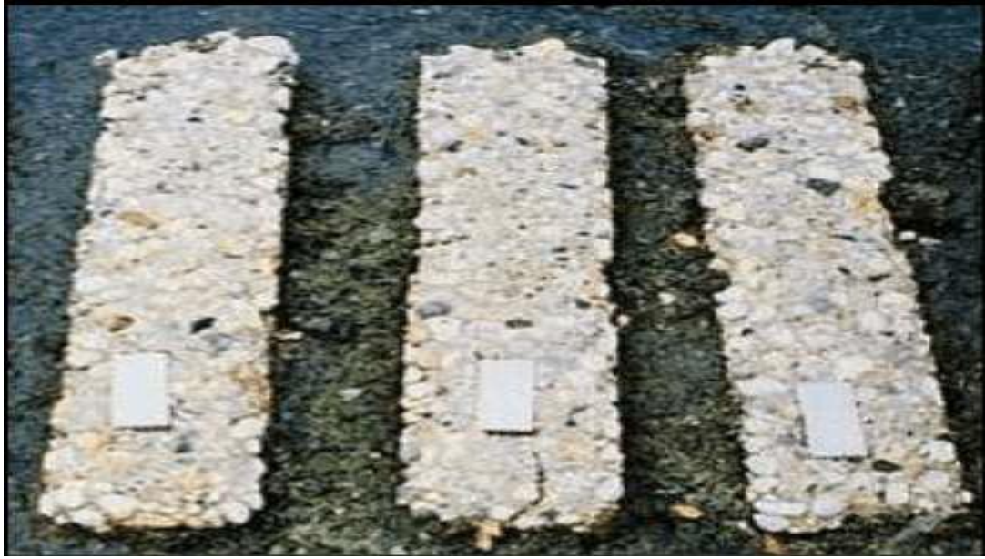
Şekil 3.3. Sülfat iyonlarının etkisine maruz kalmış beton örneği (URL-3, 2014)
