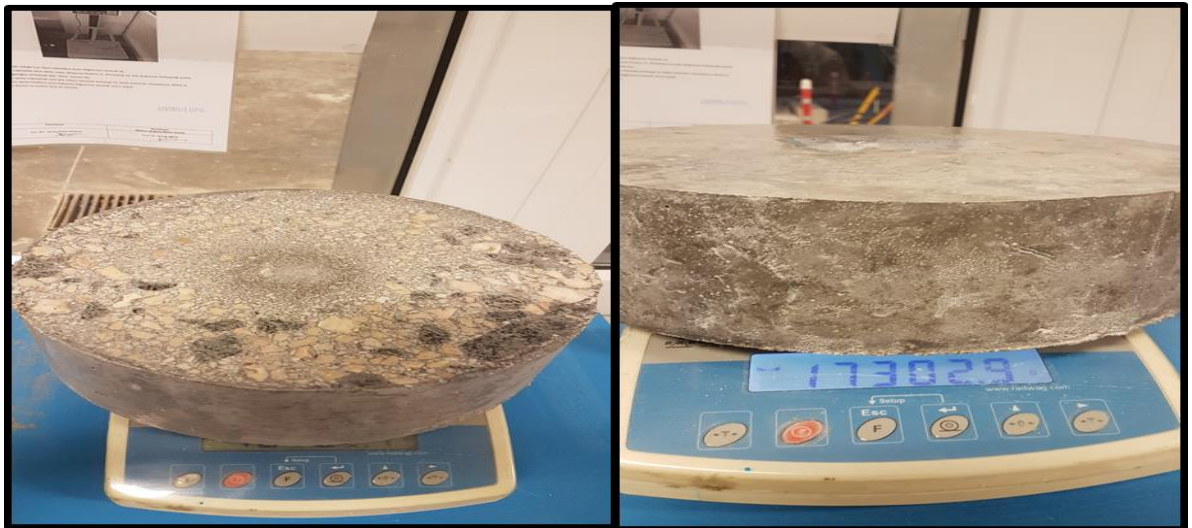
Şekil 6.7. Su altında bilyalı aşınma deneyine maruz kalan numunenin sonraki ve önceki hali
