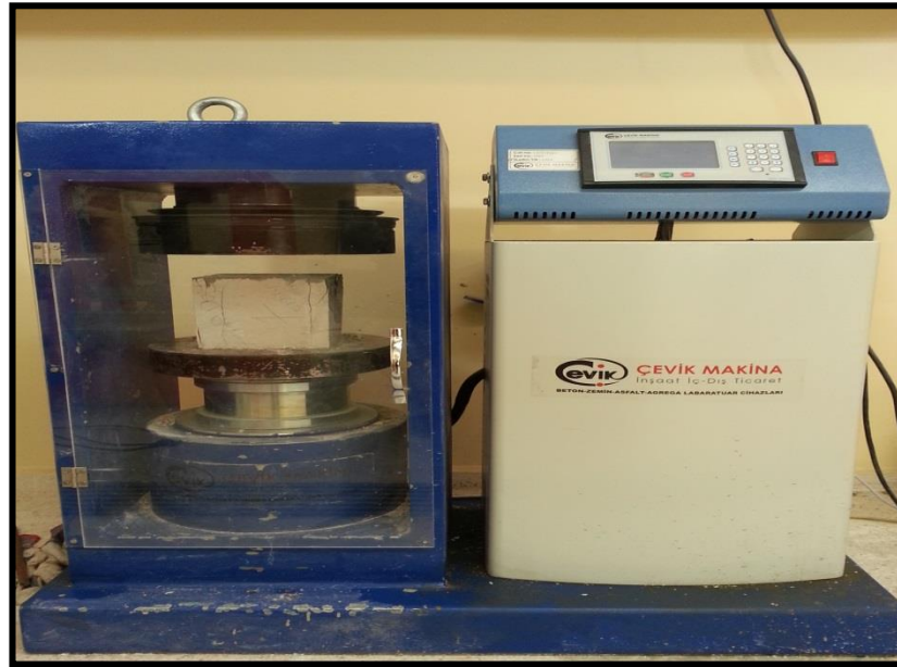
Şekil 5.14. Beton basınç dayanım deneyi cihazı ve küp numune
