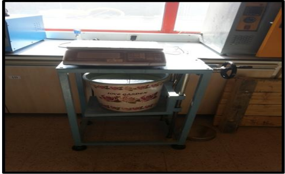
Şekil 5.9. İri agregaların özgül ağırlık tayini deney cihazı
