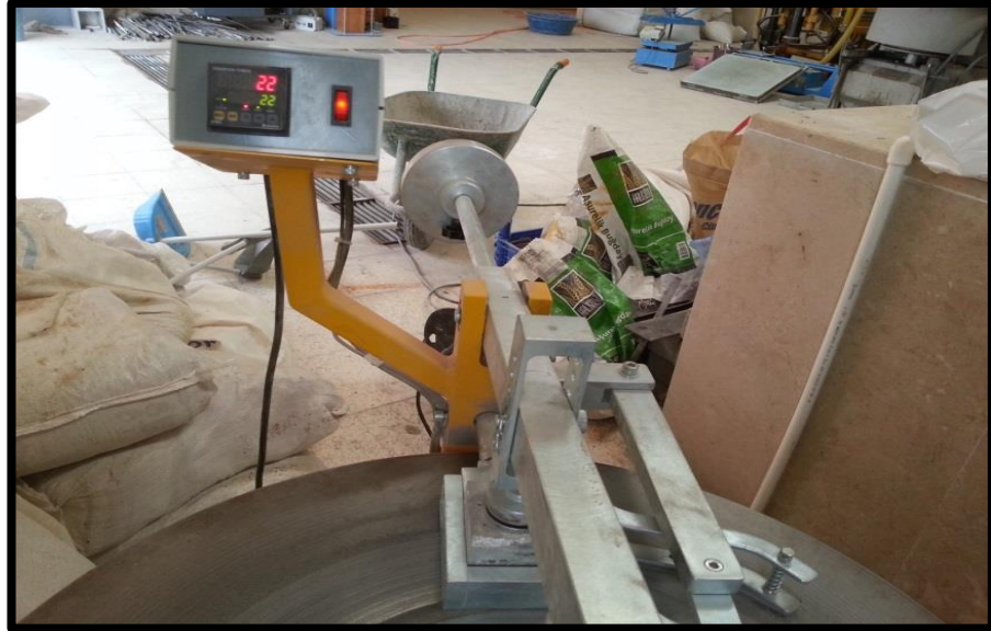
Şekil 5.15. Böhme aşınma deneyinin 22 tam devir sonrası bitişi
