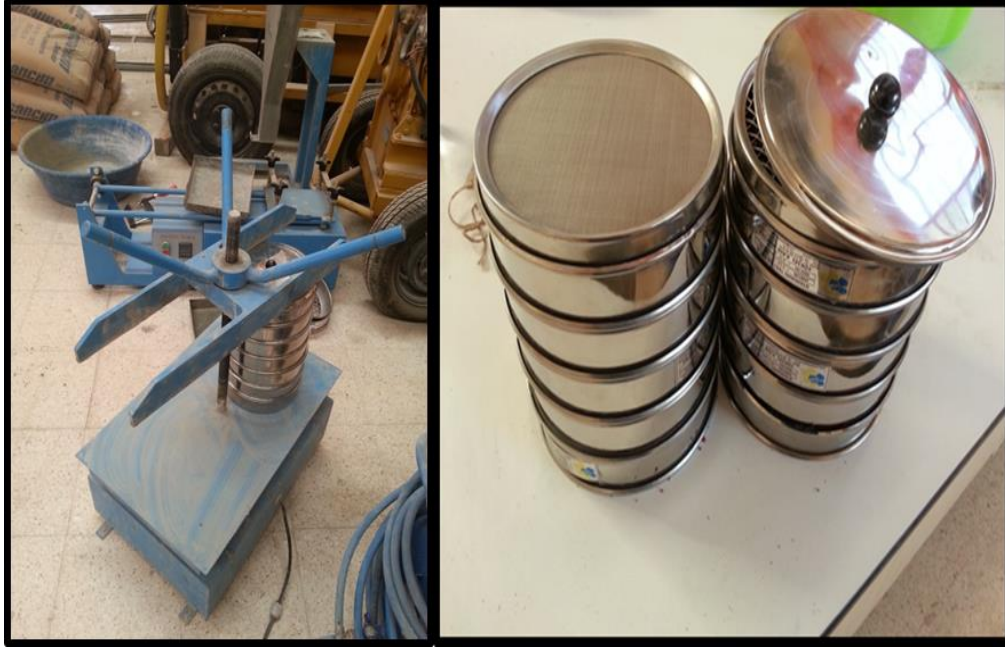
Şekil 5.7. Elek analizi deney düzeneği ve vibrasyon masası
