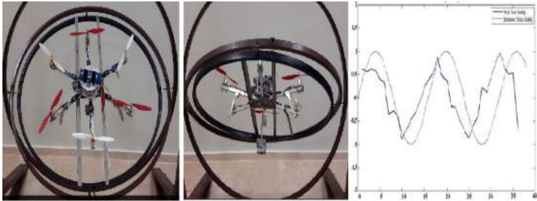
Şekil 5.3. Dört rotorlu İHA’nın yunuslama hareketi ve test sonucu.
