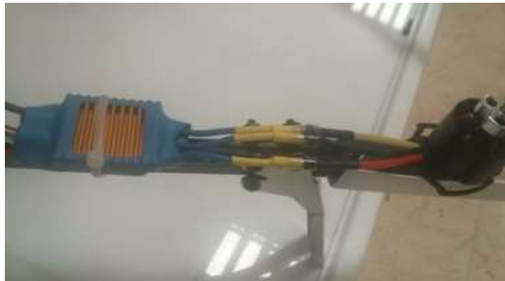
Şekil 2.4. ESC'lerin motora ve kontrol kartına bağlantısı.
