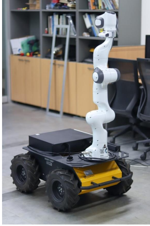
Şekil 1.2. Otonom sınıfa giren mobil robot manipulatör örneği
