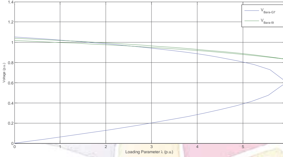
Şekil 6: Sistemde 0.1-0.1-0.8 değerlerinde ZIP Yük ile STATCOM mevcut Yük Baralarının Gerilim-Maksimum Yükleme Parametresi (5.91)
