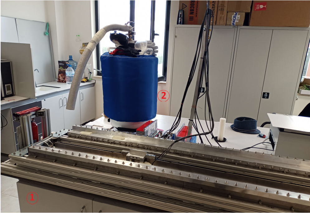
Şekil 4.1. Deney düzenegi. 1 numara ile gösterilen kısımda raylar ve lineer motor bulunmaktadır. 2 ile gösterilen ise sıvı azot tankıdır.
