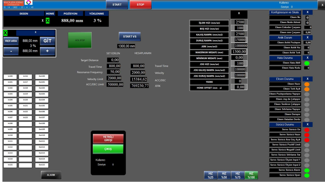
Şekil 4.4. Lineer motorun hızının, ivmesinin, jerkinin ve gideceği mesafenin ayarlanabildiği Scada ara yüzü.
