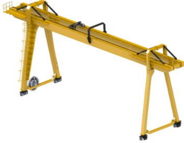
Şekil 7.11. Gezer köprülü portal vinç
