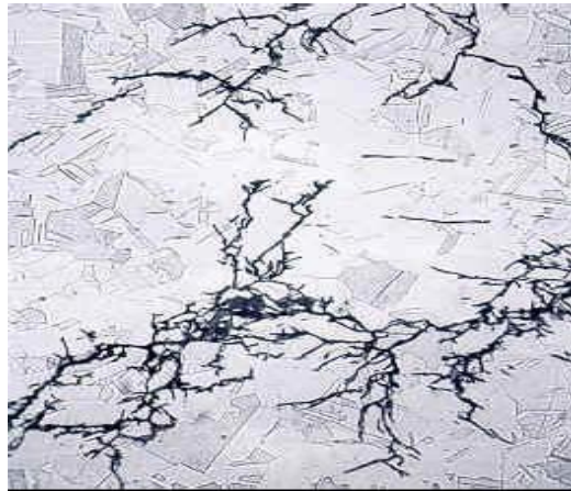
Şekil 2.13. Gerilmeli korozyon çatlama (Aksoy, 2010).
