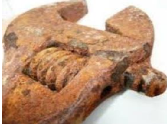
Şekil 2.5. Homojen dağılımlı (üniform) korozyon ( www.ekinokselik.com.tr , 2014).
