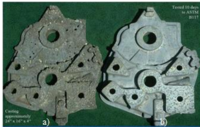
Şekil 2.11. a) AZ91C, b)AZ91E alaşımlarının tuzlu su çözeltisi altındaki korozyonu (www.magnesium-elektron.com, 2014).
