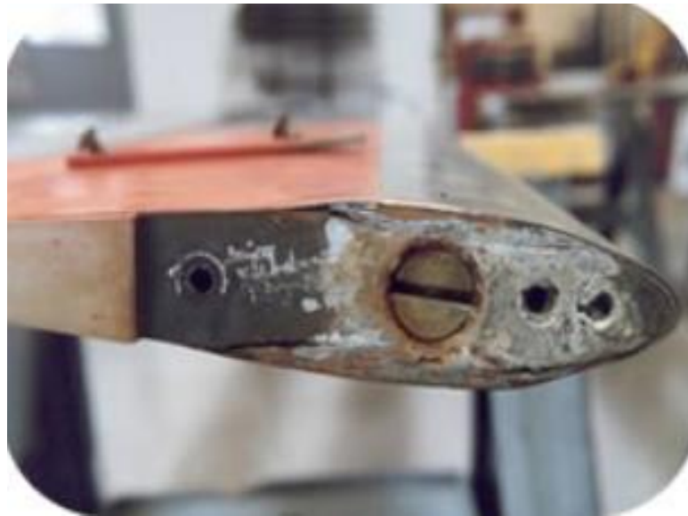
Şekil 2.9. Galvanik korozyon (www.deremetalurji.com, 2014).
