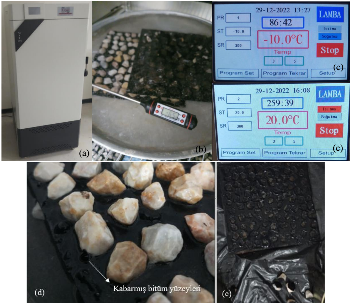
Şekil 4.12. Modifiye vialit deneyi, (a) İklimlendirme kabini, (b) Eksi sıcaklıkta numuneler, (c) İklimlendirme kabinine girilen program, (d) Kabarmış yüzeyler, (e) Eksi sıcaklıkta plakadan tamamen düşen agregalar
