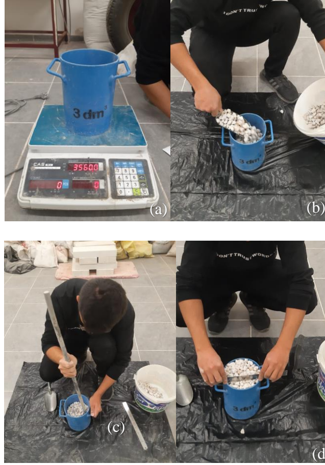
Şekil 4.4. Birim hacim ağırlık deneyi, a) Hacmi belli kabın ağırlığının saptanması, b) Kürek yardımı ile agregaların kaba doldurulması, c) Kaba doldurulan agregaların şişleme işlemi, d) Kabın üst kısmındaki agregaların alınması
