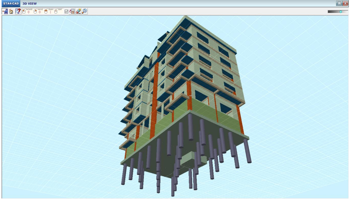
Şekil 5.15. Sta4cad Temel Altı Fore Kazık Modellemesi Görşeli
