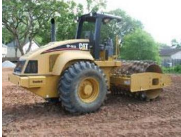
Şekil 3.1. Yüzeysel Kompaksiyon Uygulaması
