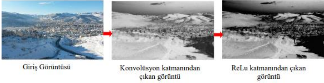
Şekil 3.3. Konvolüsyon ve ReLu katmanlarının görüntü üzerindeki etkisi
