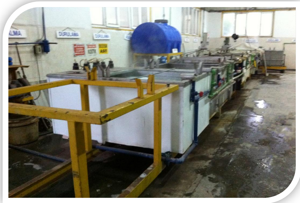
Şekil 2.5. Örnek bir akımsız nikel kaplama tesisi (Kurvalf San. Tic. Ltd. Şti. Kaplama Tesisi).
