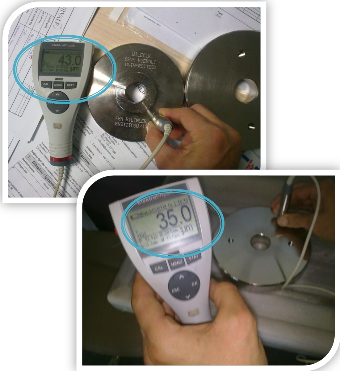
Şekil 3.10. Korozyon testine (tuz testi) tabi tutulacak olan parçaların kaplama kalınlık ölçümleri.
