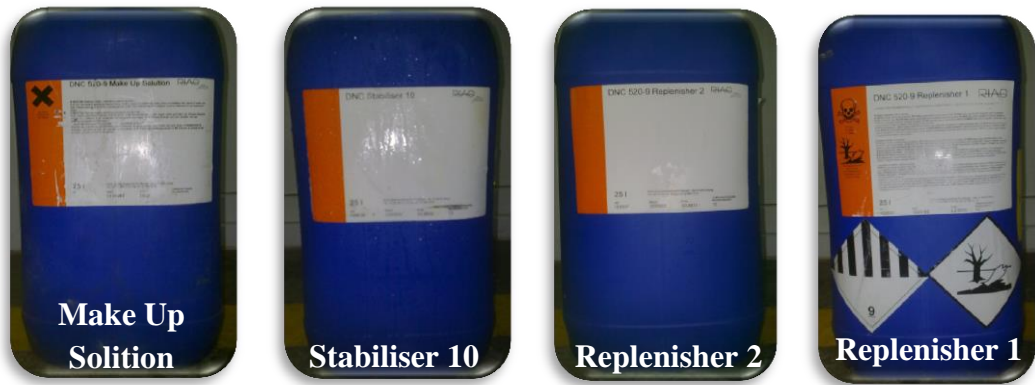
Şekil 3.5. Akımsız nikel-fosfor banyo kurulumu için gerekli ürünler.
