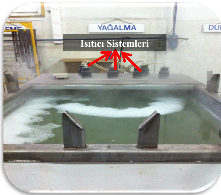
Şekil 3.4. Sıcak yağ alma banyosu.
