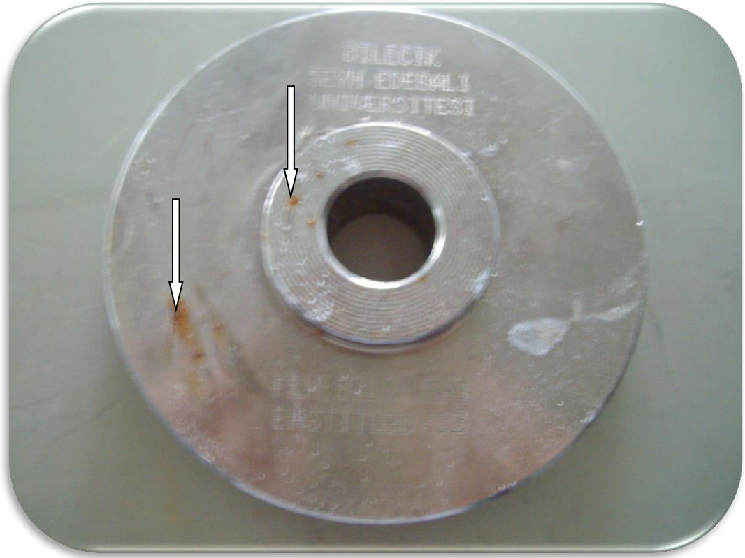
Şekil 3.16. Isıl işlemsiz numunenin tuz püskürtme korozyon testi sonrası.
