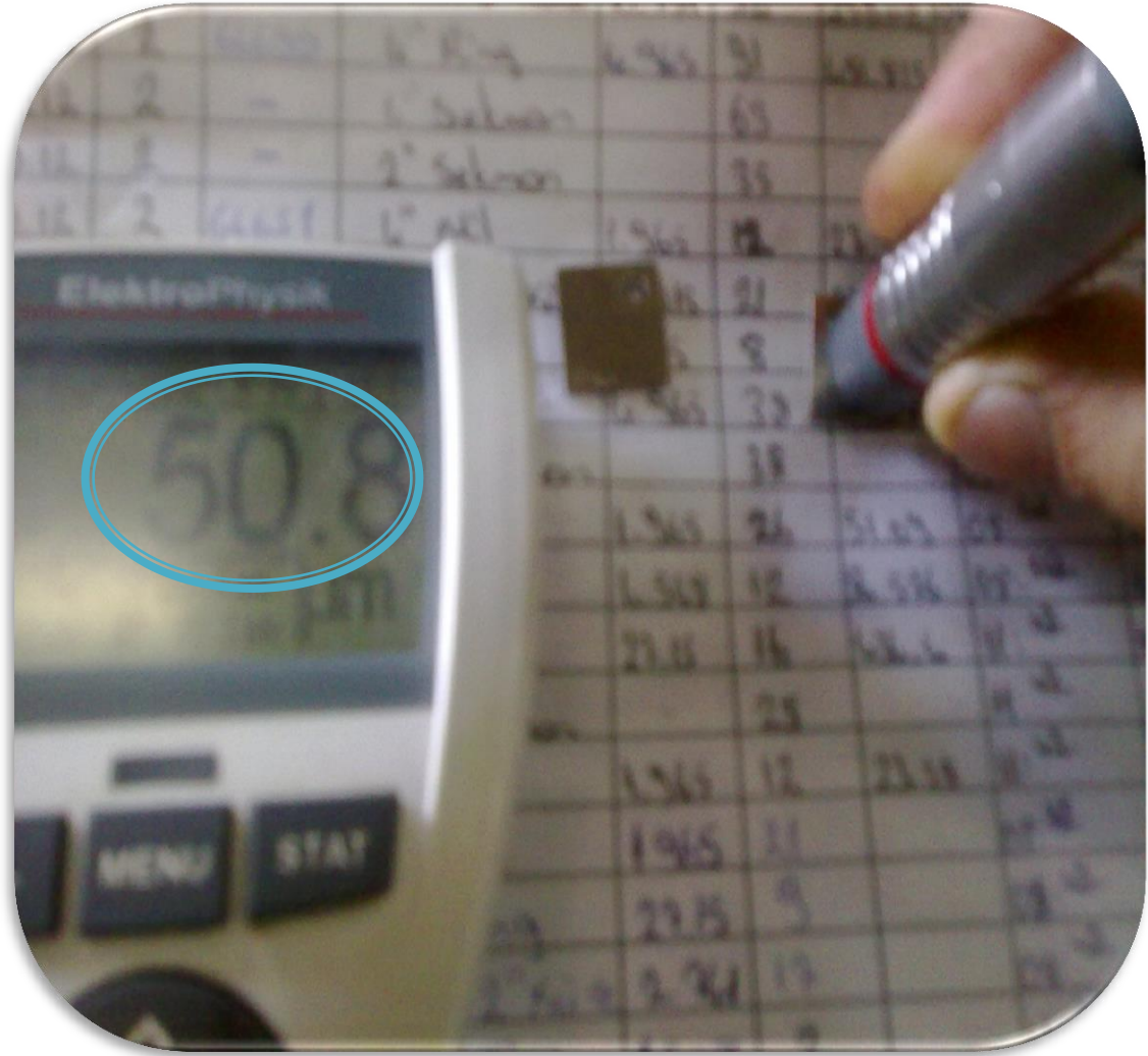
Şekil 3.11. Test ve analizleri yapılacak parçaların kalınlık ölçümleri.
