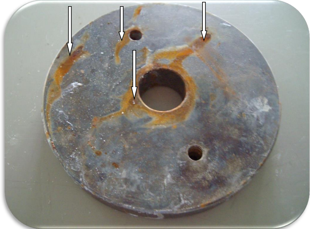
Şekil 3.17. Isıl işlemlili numunenin tuz püskürtme korozyon testi sonrası.
