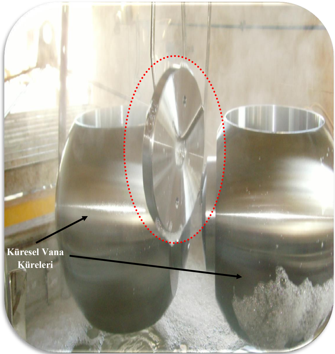
Şekil 3.8. Korozyon testine tabi tutulacak parçanın kaplanması (Sıcak yağ alma işleminde).
