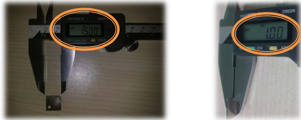
Şekil 3.1. Kullanılan numunelerin kalınlıklarının kumpas yardımıyla ölçümü.
