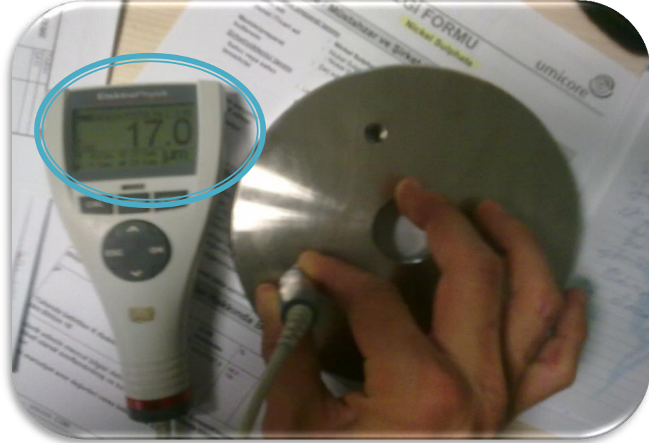
Şekil 3.12. Isıl işlem sonrası kaplama kalınlık ölçümünün yapılması.
