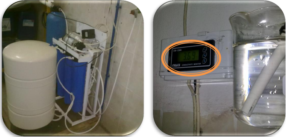
Şekil 3.2. Saf Su üretim cihazı ve iletkenlik ölçümü.
