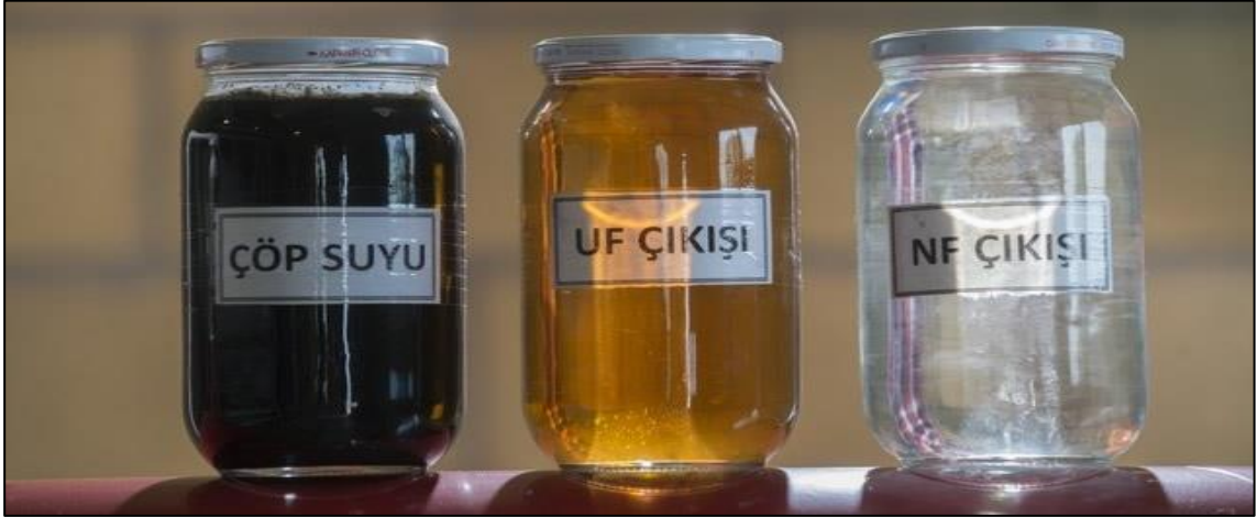
Şekil 4.13. Çöp Suyu Arıtma Aşamaları
