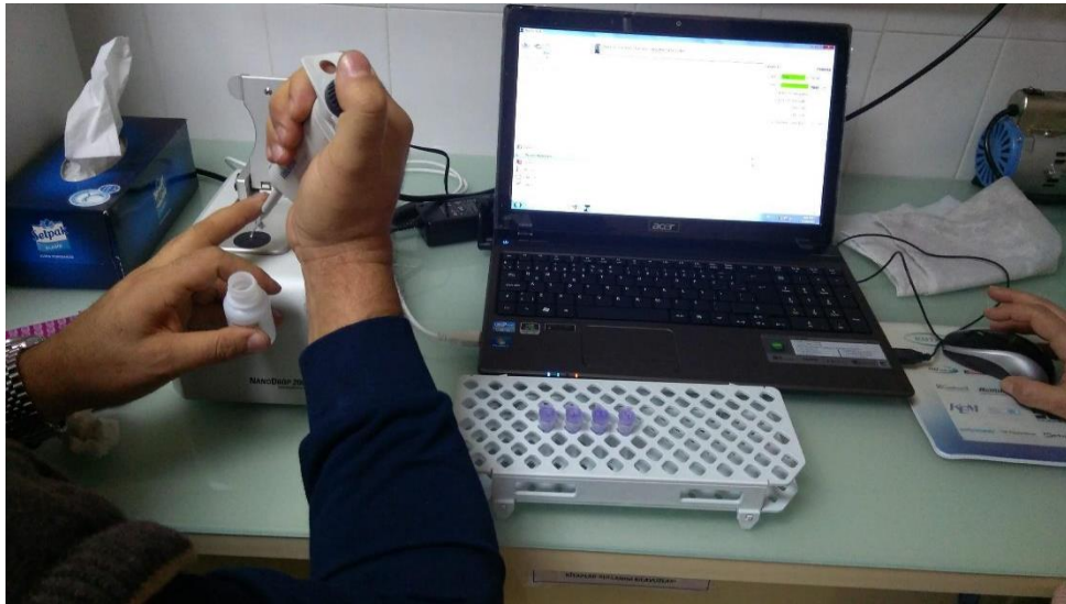
Şekil 2.2. Nanodrop UV-Spektrofotometre ile DNA'nın kalite ölçümü
