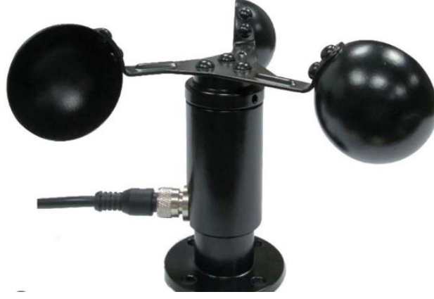
Şekil 3.4. Delta Ohm HD 53.D rüzgâr hız ölçüm sensörü.
