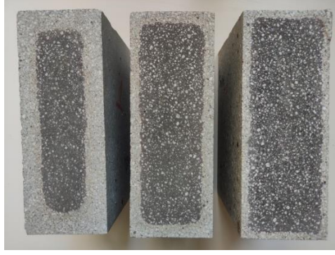
Şekil 6.8. 1350 °C, 1400 °C, 1450 °C sinterlenen tuğlaların iç kesit resimleri
