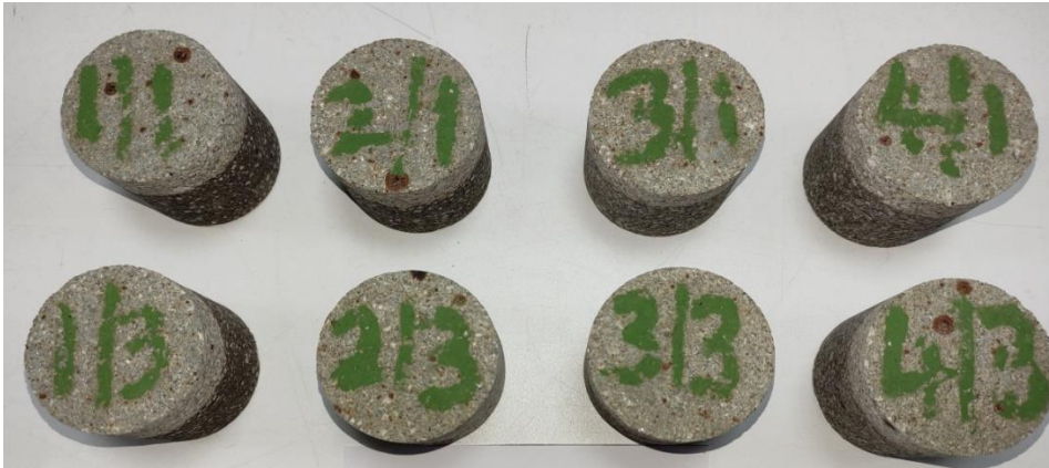
Şekil 6. 24. Suda termal şok test numuneleri
