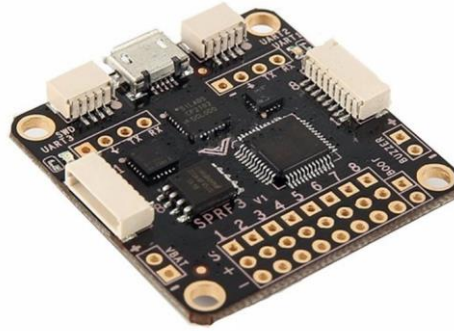
Şekil 3.6. SP Racing F3 Uçuş kontrol kartı.
