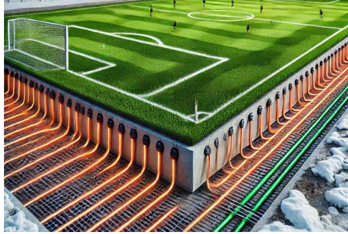
Şekil 3.5. Çim Sahalarda Yerden Isıtma Sistemi
