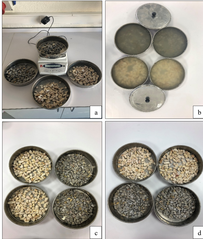
Şekil 5.5. a: Deney öncesi numune, b: Çözelti içerisindeki numune, c: 1.deney sonucu numune, d: 5.deney sonucu numune
