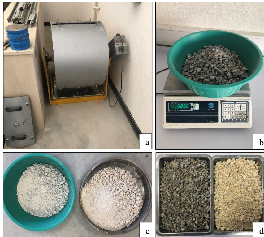
Şekil 5.4. a: Los Angeles aşınma cihazı, b: Deney öncesi numune, c: Deney sonrası numune, d: Deney sonrası yıkanmış numune
