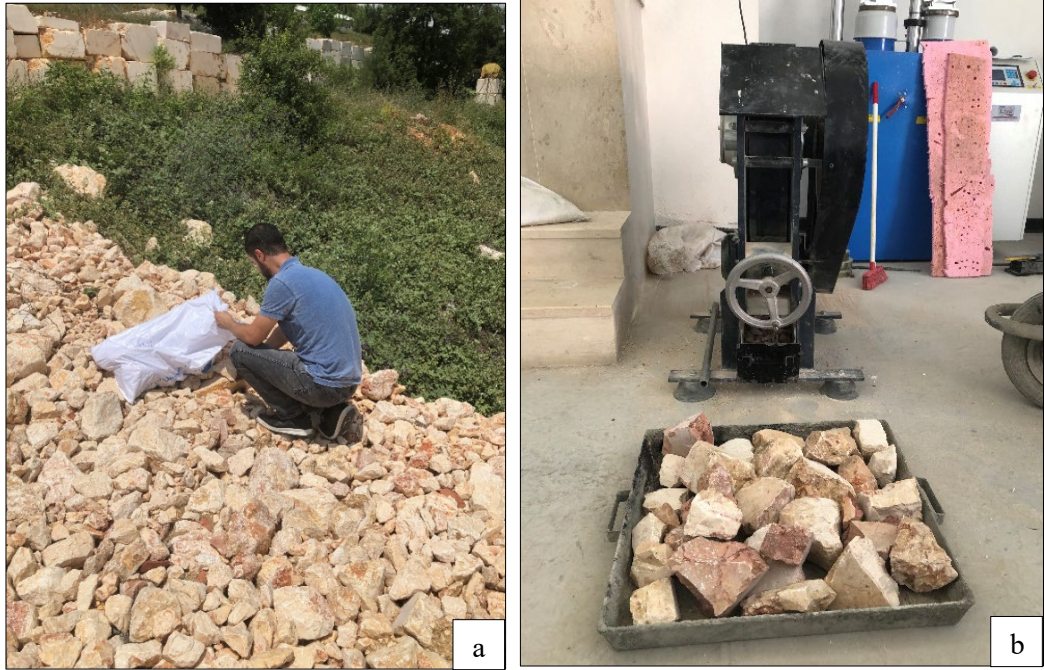
Şekil 5.2. a: Mermer ocağından mermer atığı temini, b: Mini konkasör yardımı ile malzeme kırımı
