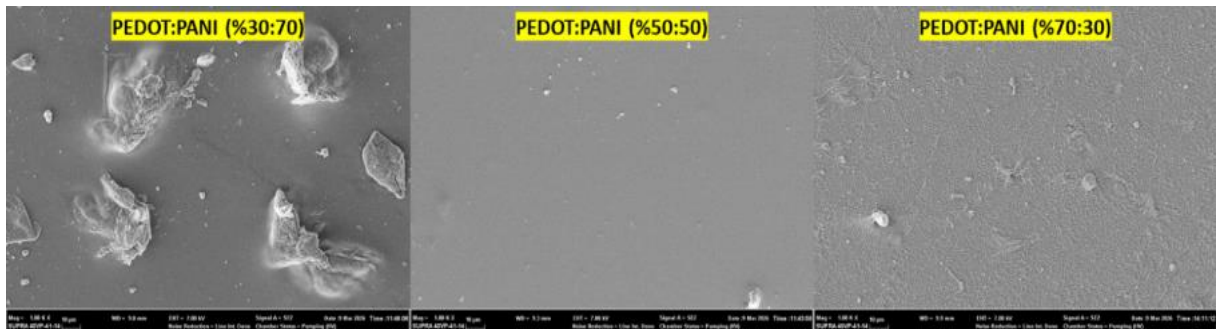
Şekil 4.12. Aynı büyültmelere sahip, farklı oranlarda PEDOT:PANI-PVA filmlerine ait SEM görüntüsü. (soldan sağa: kütlece % 30:70 PEDOT:PANI; %50:50 PEDOT:PANI; ve %70:30 PEDOT:PANI).
