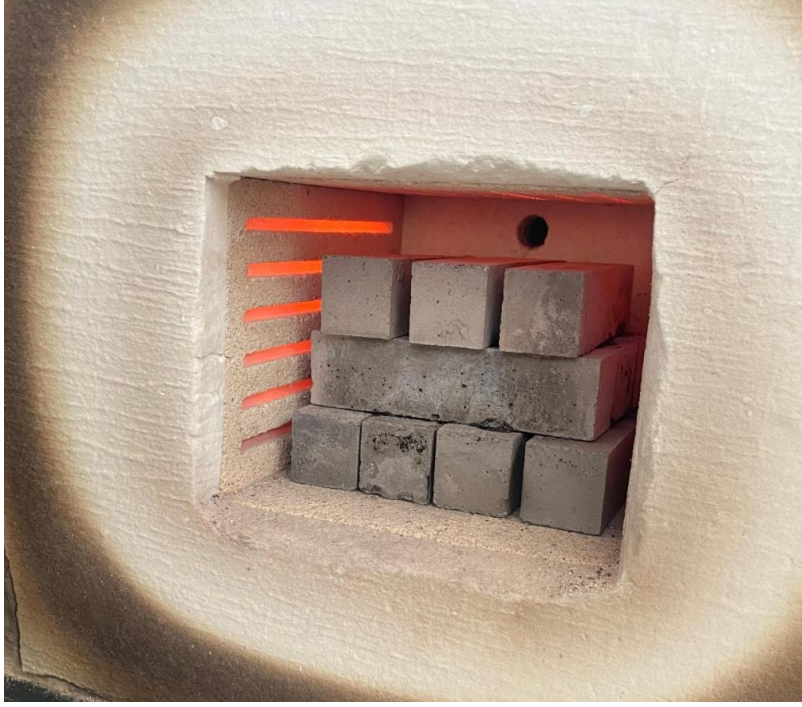
Şekil 3.14. Harç Numunelerine Yüksek Sıcaklık Uygulaması
