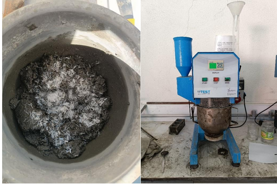
Şekil 3.4. Mikser ve Polipropilen Liflerin Karışıma Dahil Edilmesi
