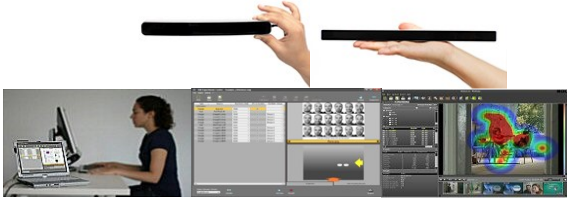
Şekil 7: SMI Taşınabilen Göz İzleme Cihazı
