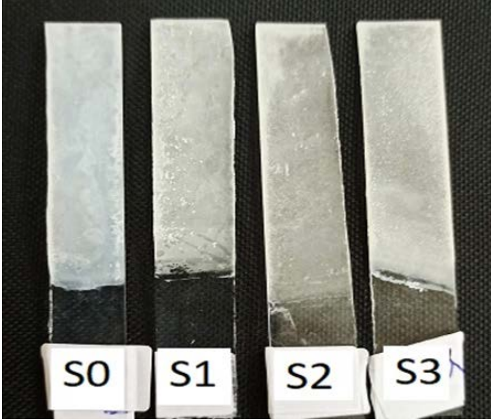
Şekil 2.8. ZnO ince filmlerinin fotoğrafları.
